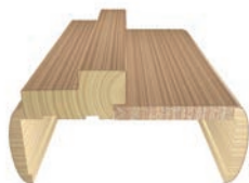
Разрез коробки и доборной доски в сборе
